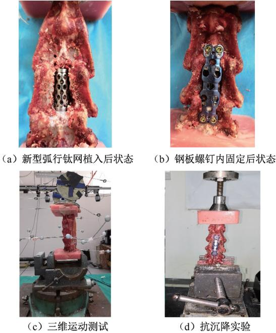
图3 山羊颈椎模型制作及实验过程
