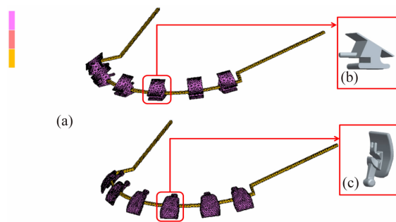
图1 实验模型 (a)两种槽沟舌侧托槽三维有限元模型,(b)水平槽沟舌侧托槽,(c)垂直槽沟舌侧托槽
